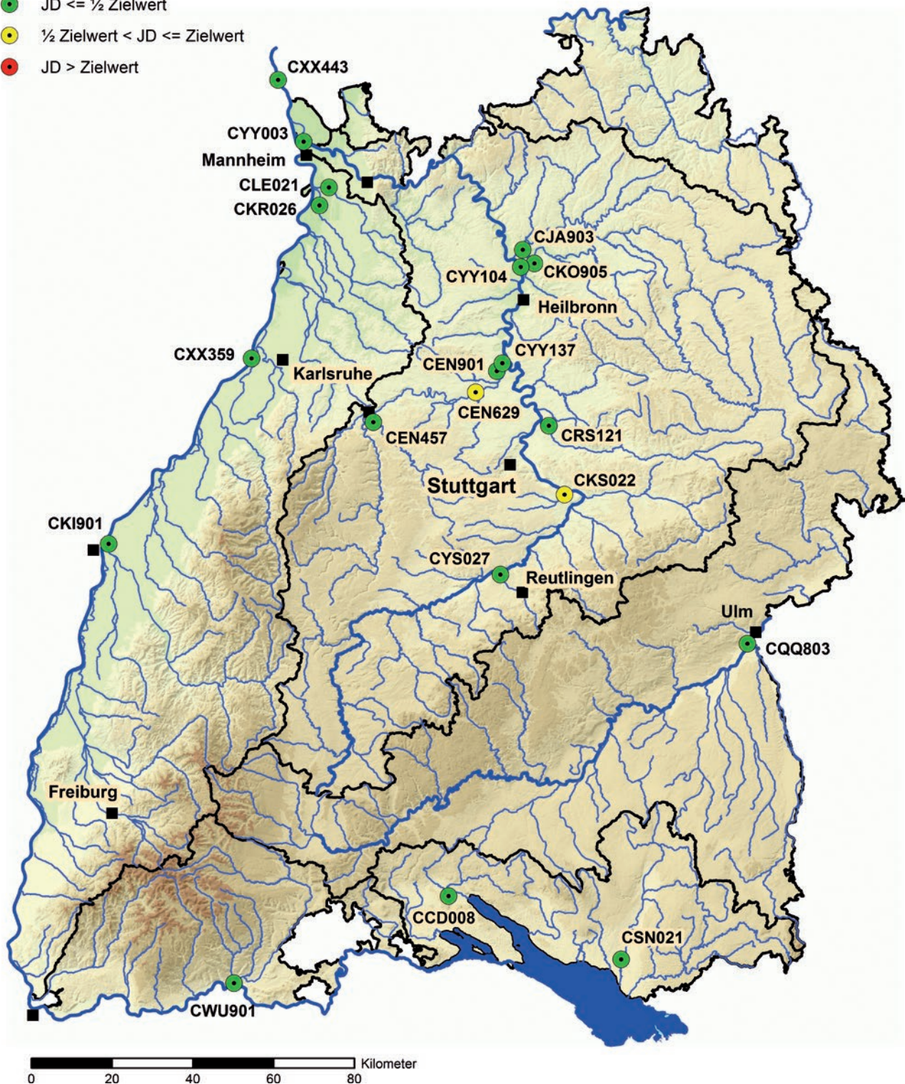
Abbildung 6.8: Beurteilung der Gewässerbelastung für Sulfamethoxazol auf Basis des UQN-Vorschlags von 0,6 µg/L im Jahresdurchschnitt (JD) von Mai 2012 bis April 2013
