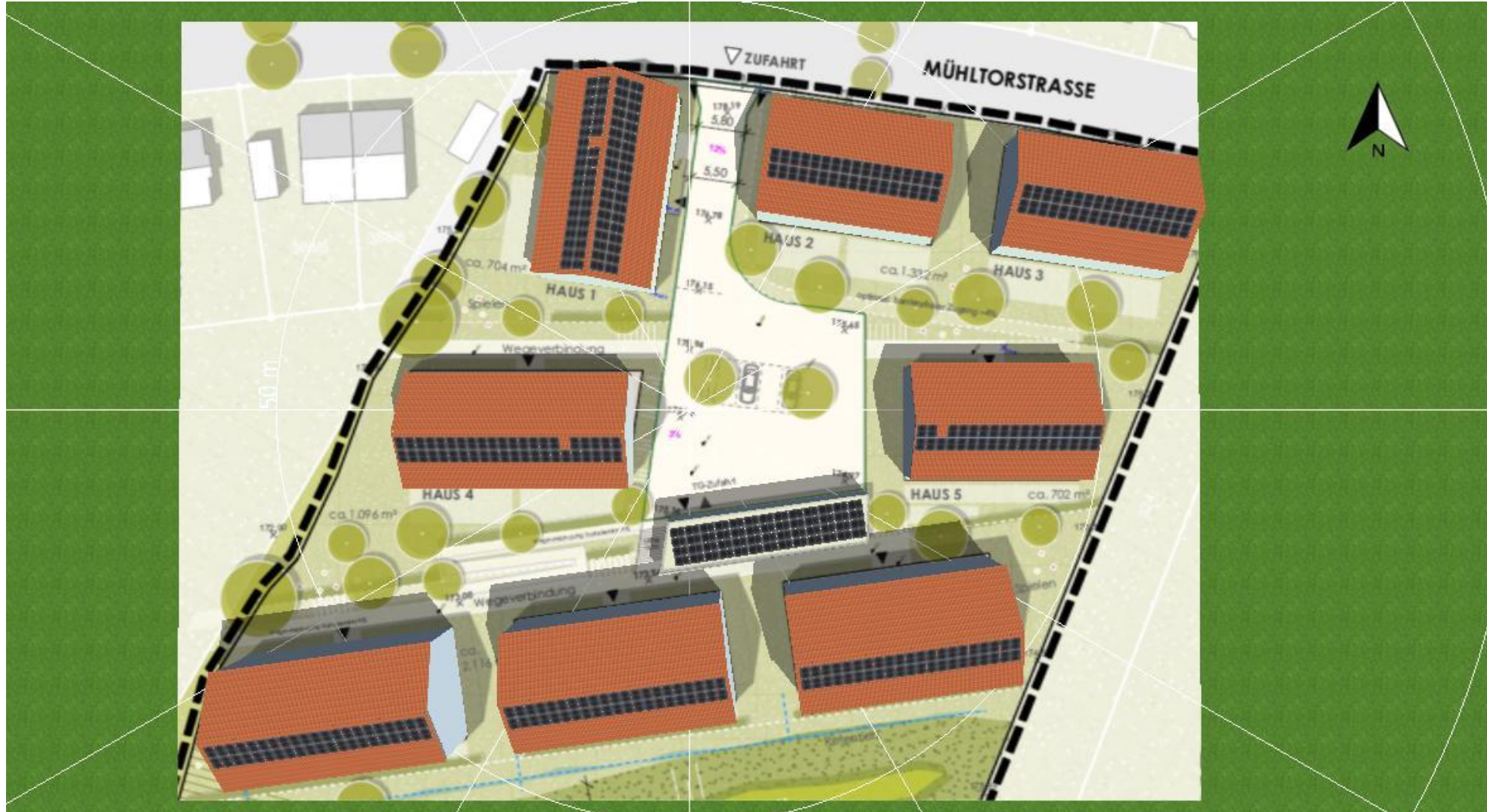
3D-Darstellung der PV-Belegung aus PV-Auslegungssoftware
