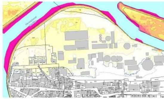
Überflutungstiefe bei HQ 100 :
