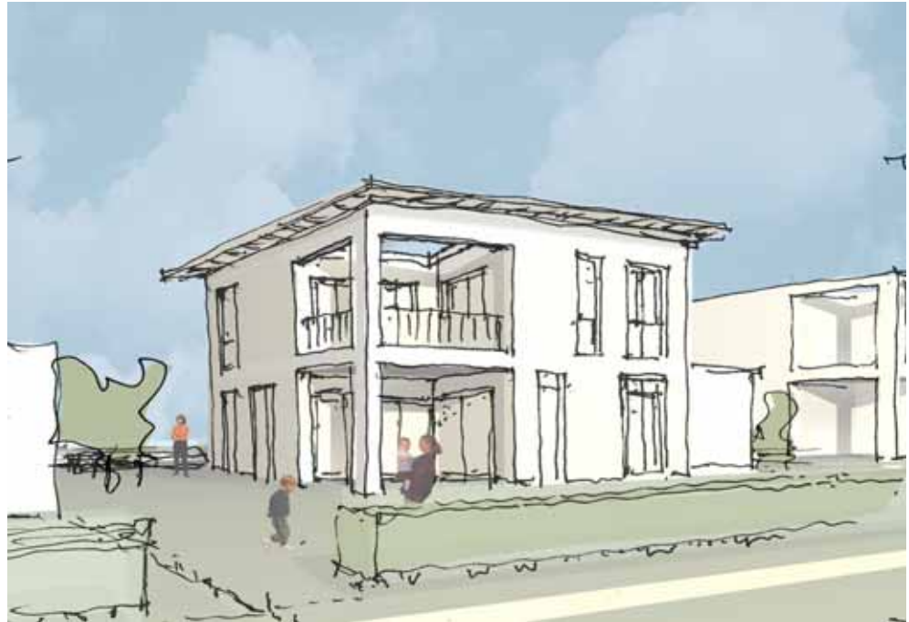
Das Punkthaus mit Patio. Ein auskragendes Flachdach mit Holzuntersicht ist ein schöner Abschluss des Hauses und „beschrmt“ die Bewohner.
