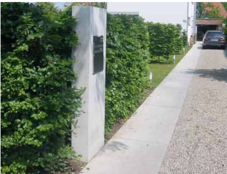
Abb. 4.5 Zufahrt und Zugang fein differenziert, Kiesbelag ist offen für Versickerung und wirkt angenehm.
