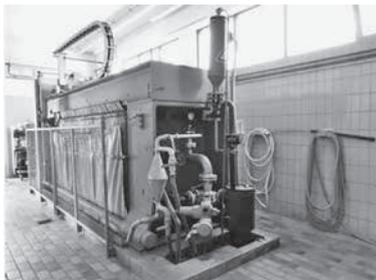
Abbildung 1: Kammerfilterpresse
