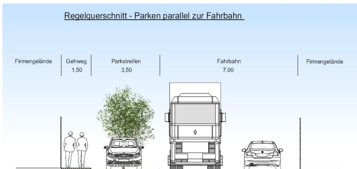
Abb. 8: Regelquerschnitt – Parken parallel zur Fahrbahn (Quelle: IFK-Ingenieure)
