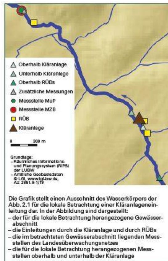
Abb. 2.2: Prinzipielle Darstellung der lokalen Betrachtungsebene am Beispiel einer Kläranlageneinleitung in Kombination mit RÜB-Entlastungen
