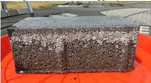
Da die Deckschicht undurchlässig ist, fallen Probleme von komplett haufwerksporigen Betonsteinen wie eine größere Frostempfindlichkeit, geringere Druckfestigkeit, Ausblühungserscheinungen durch aufsteigendes Wasser und Algenbildung durch mögliche hohe Feuchtigkeit an der Oberfläche weg. Außerdem lassen sich die Oberflächen vielfältiger gestalten, da die Steine geschliffen oder gestrahlt werden können. Typische Einsatzbereiche sind Parkplätze, Wohn-
