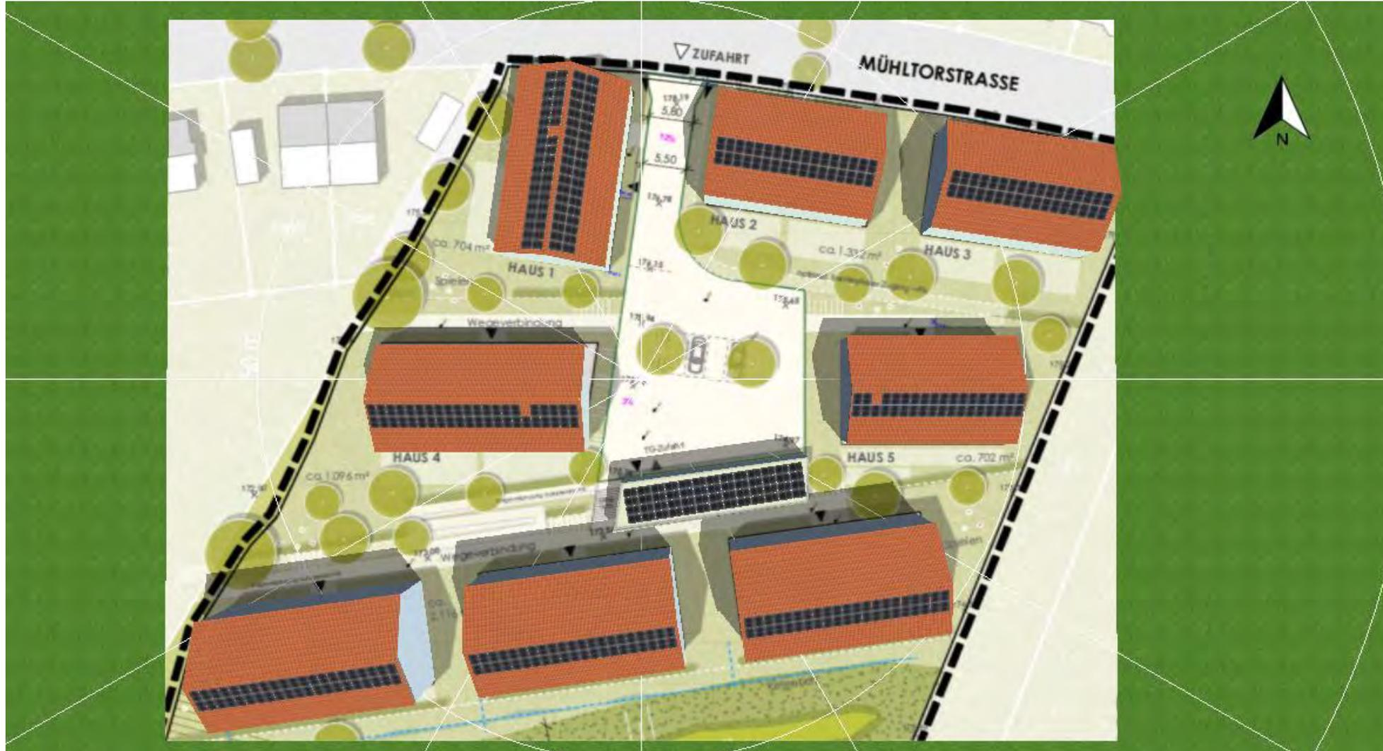
*3D-Darstellung der PV-Belegung aus PV-Auslegungssoftware*
